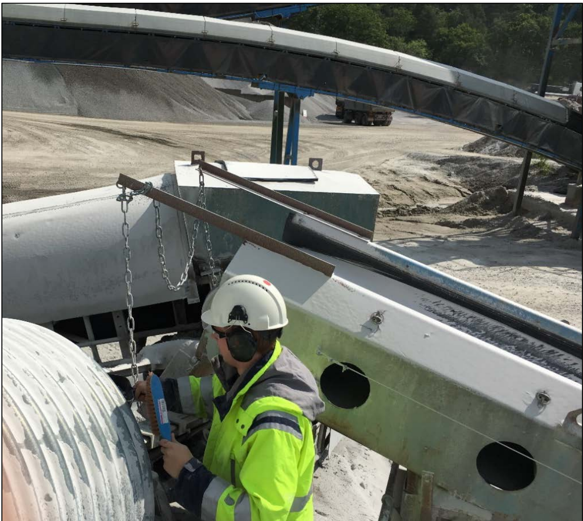
Figur 4. Bilden visar provtagningen med beltcut metoden.
